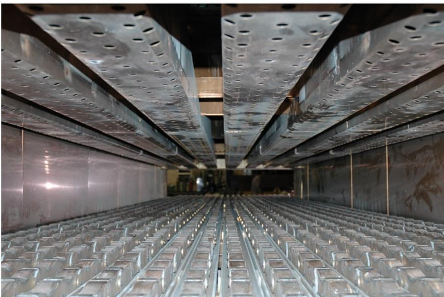
**Bild 3:** Düsenfeld für Prallströmung
