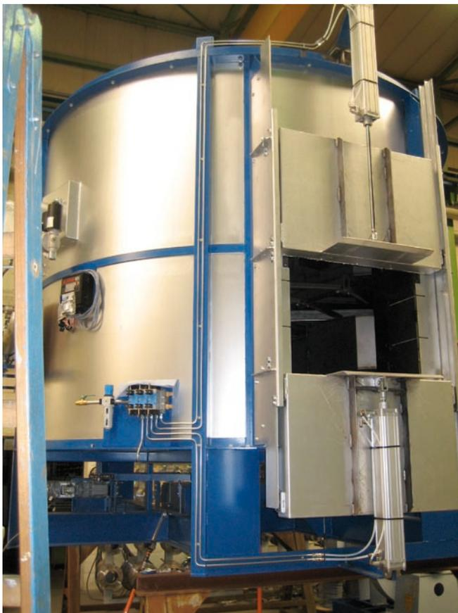
**Bild 11:** Drehherdofen mit Jet-Heating
