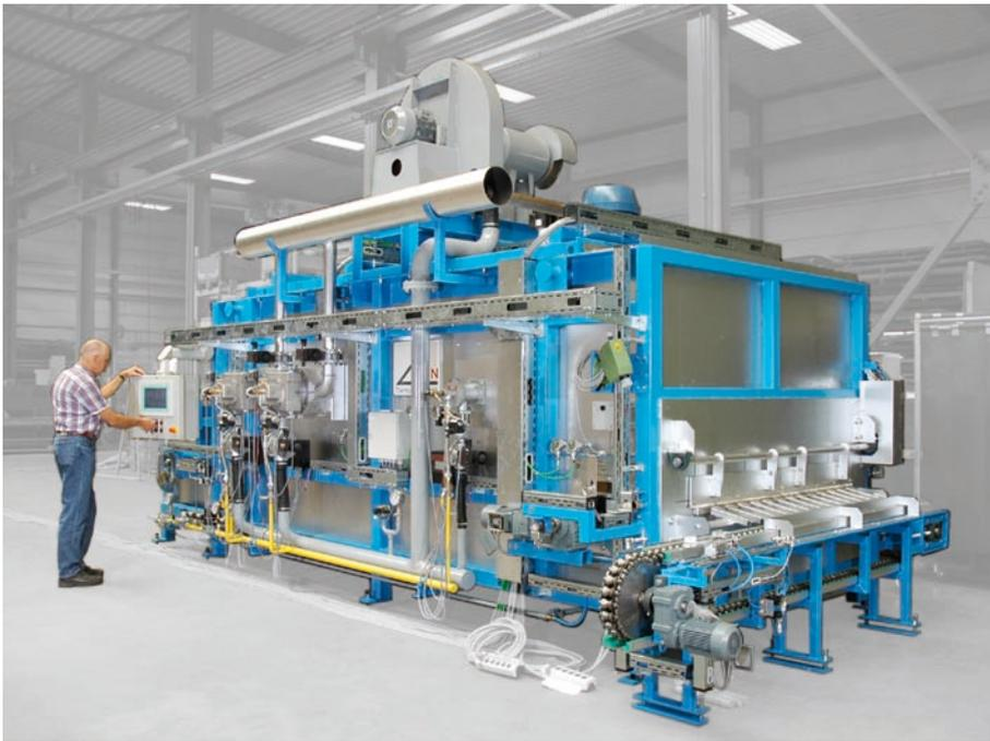
**Bild 2:** „Jet-Heating“ Kammer-Ofenanlage für Aluminiumbauteile
