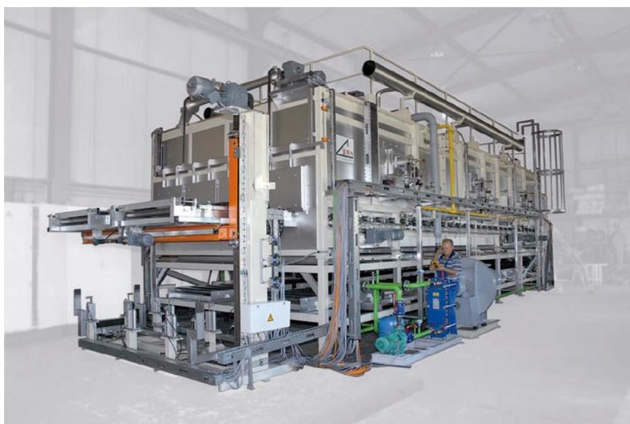
**Bild 9:** Rollenherd-Durchlaufofen mit Jet-Heating
