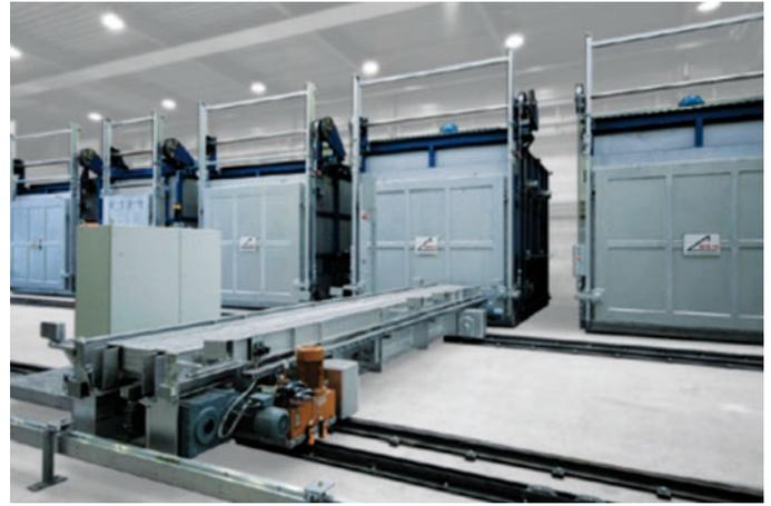
**Bild 8:** „Jet-Heating“-Kammerofenanlage für Aluminiumbauteile (Quelle BSN)
