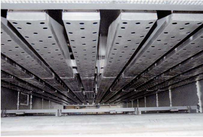
**Bild 7:** Düsenfeld für Prallströmung (Quelle BSN)
