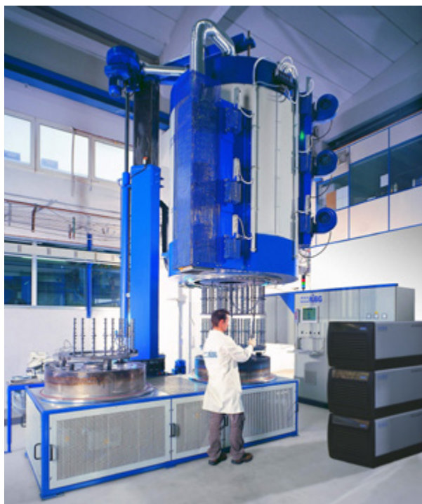
Bild 4: Plasmanitrieranlage mit der Option der DLC (Diamond-Like-Carbon)-Beschichtung (Hersteller Rübzig)
