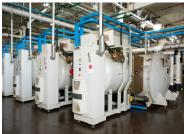
Bild 2: Modulare Vakuumhärteofenanlage Typ ICBP (Hersteller ECM)
