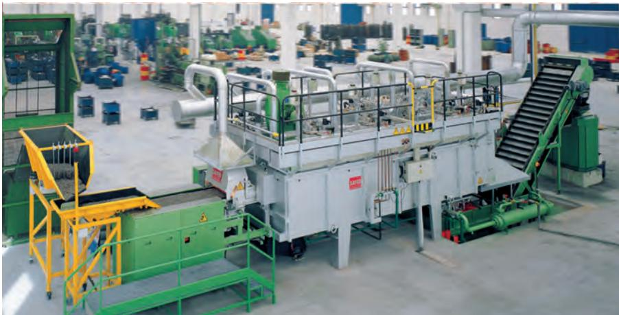
**Bild 4:** Förderbandofen zum Nitrocarburieren im Oxycad NT®-Verfahren (Safed)
