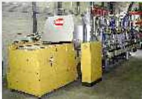
**Förderbandöfen Typ TC/TCG** ohne Muffel, mit integriertem Abschreckbehälter. Neben den Vorteilen der Baureihe T/TG vor allem für besonders große Kapazitäten geeignet. Härten, Aufkohlen, Karbonitrieren mit Öl- oder Polymer-Abschreckung, Bainit- und Martensithärten mittels Salz-Abschreckung, Zwischenstufen-Vergüten.
