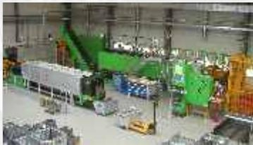
**Komplette Wärmebehandlungs-Linien** bestehend aus Beschickung, Härteofen, Abschreckung in Salz, Öl oder Emulsion, Reinigungsanlage vor und nach der Wärmebehandlung, Anlassofen. Ergänzt durch Schutzgasgeneratoren und Prozess-Steuerung.
