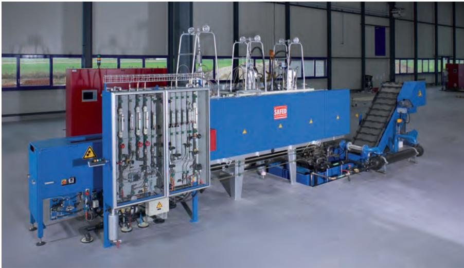
**Bild 2:** Förderbandofen zum Nitrocarburieren im Oxycad NT®-Verfahren (Safed)
