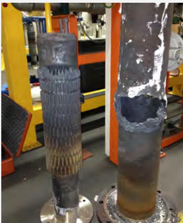
**Bild 3:** Schadensfall an einem Stahlmantelrohr/Rekuperatorbrenner
