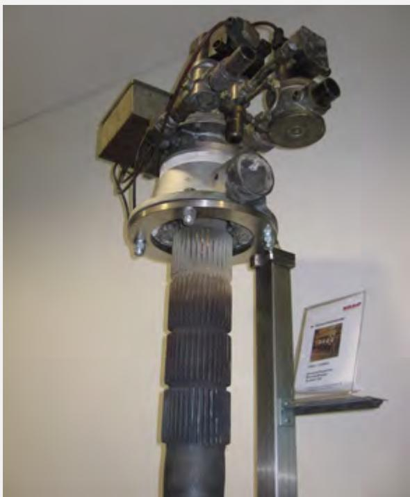
**Bild 2:** Im Dauereinsatz betriebener Noxmat-Rekuperatorbrenner von 1991
