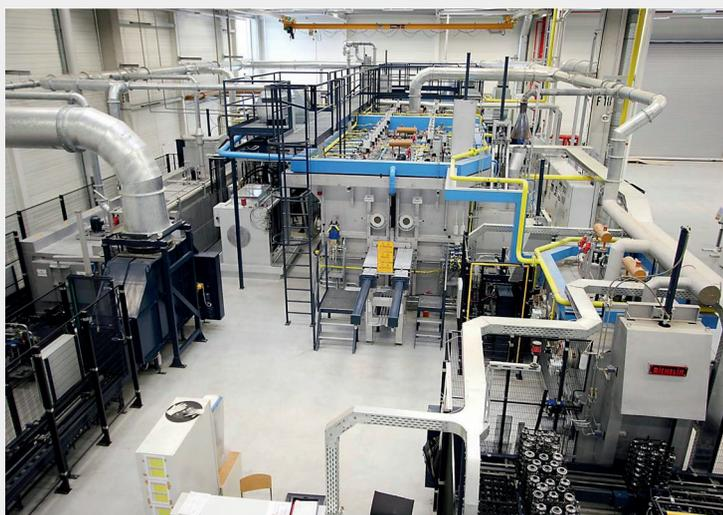
**Bild 1:** Gasaufkohlungs-Durchstoßofenanlage
