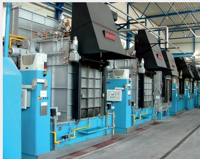
**Bild 2:** Mehrzweckkammerofenanlage
