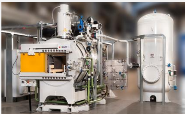
Bild 1: Doppelkammerofen mit Gasabschreckung (Quelle aller Bilder: ECM Technologies)
