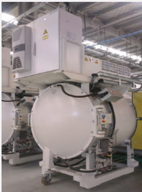
Bild 5: Wartungstür der ICBP® Jumbo-Heizkammer
