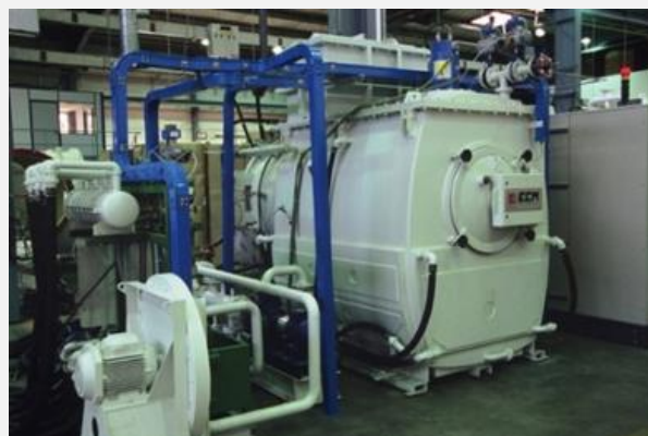
Bild 2: Doppelkammerofen mit Ölabschreckung
