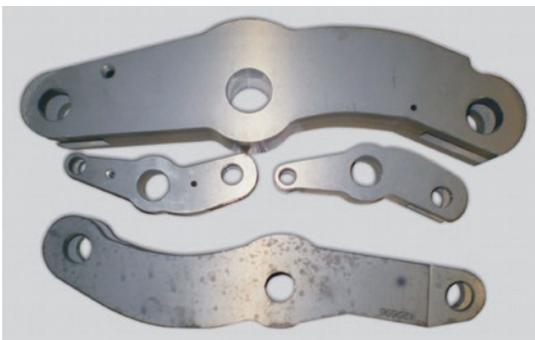
**Bild 9:** Vergleich Hybridreinigung (Oben) und Lösemittelreinigung (unten)
