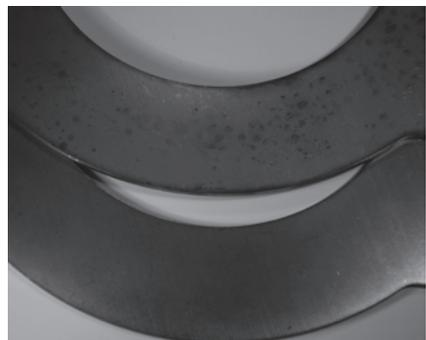
**Bild 10:** Vergleich Hybridreinigung (unten) und wässrige Reinigung (oben)
