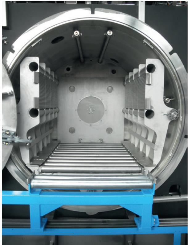
**Bild 6:** Reinigungskammer
