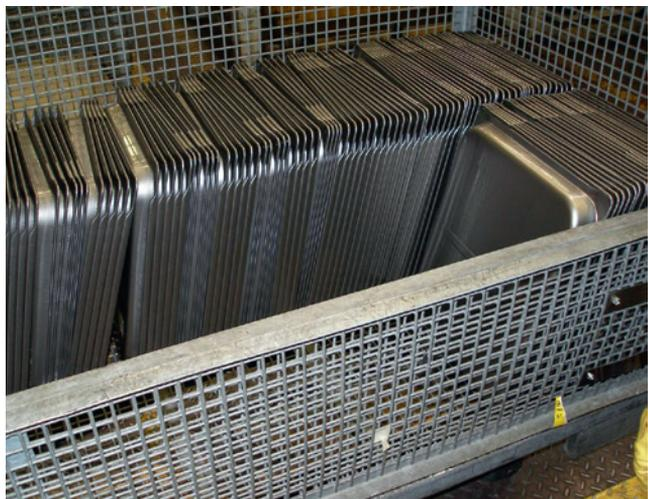
**Bild 8:** Enge Chargierweise mit Hybrid-Reinigung
