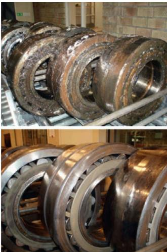
**Bild 7:** Vor (oben) und nach Kohlenwasserstoff-Reinigung (unten)
