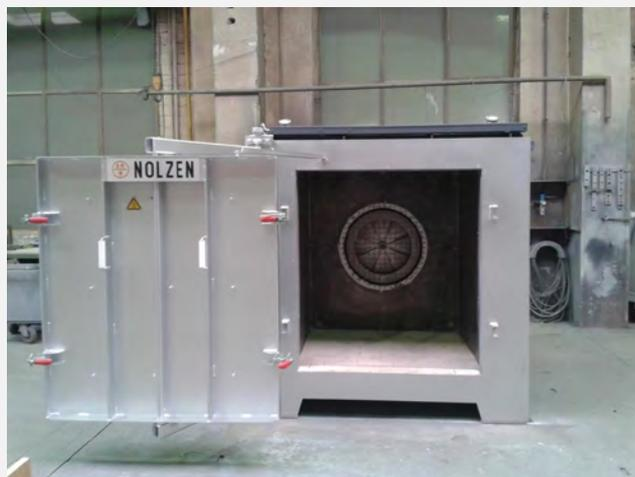
Bild 5: Umwälzofen mit optimiertem Umwälzsystem
