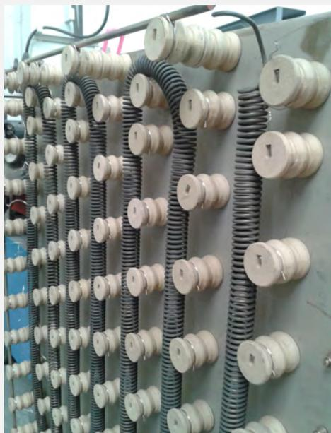
**Bild 2:** Gewickelte Heizwendel auf der Luftleitwand
