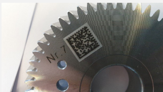
Bild 6: Mit Laser markiertes Zahnrad
