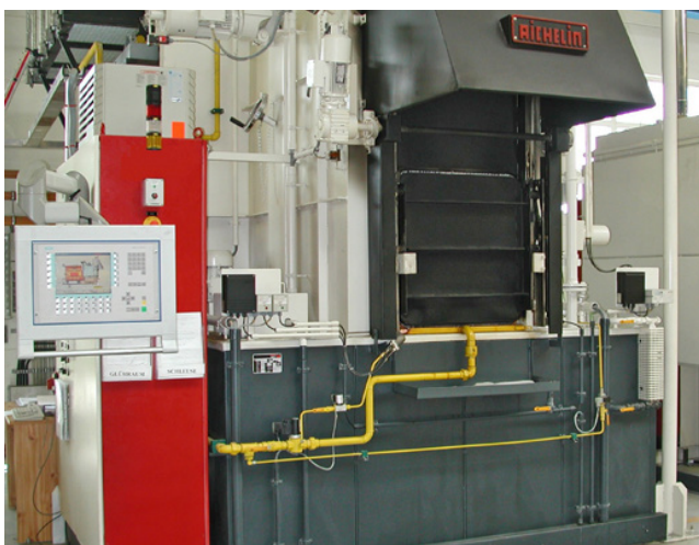
Bild 6: Mehrzweckkammerofen zur Wärmebehandlung von Wälzlager
