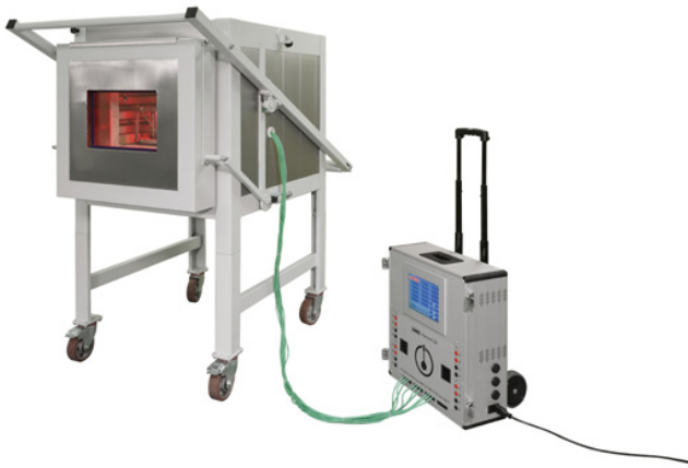
Bild 2: Das JUMO thermoCOR-Messsystem (rechts) ist eine einfach zu handhabende Kompaktlösung zur Kalibrierung nach CQI-9
